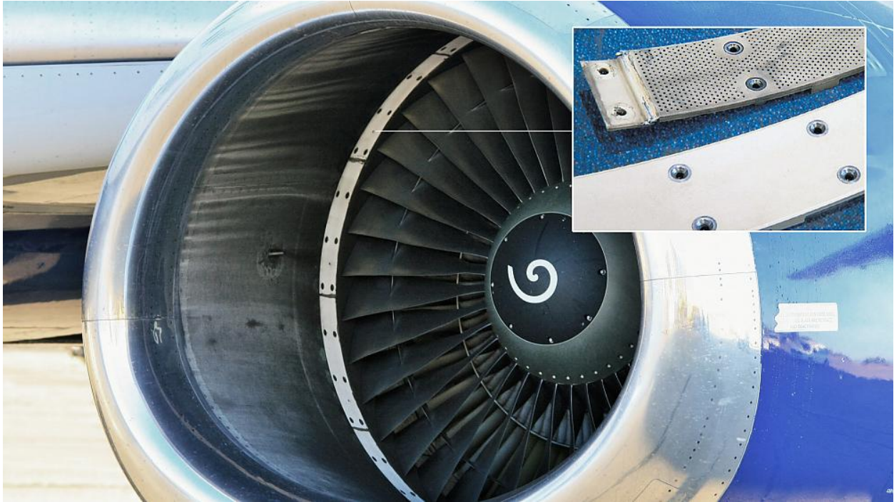
Neue Auskleidungen im Triebwerk der Boeing 737 reduzieren den Lärm spürbar. Im Bild oben rechts: eine alte und eine neue Auskleidung im Vergleich. (Quelle: CC0 Public Domain, kleines Bild: Deutsche Lufthansa AG)
